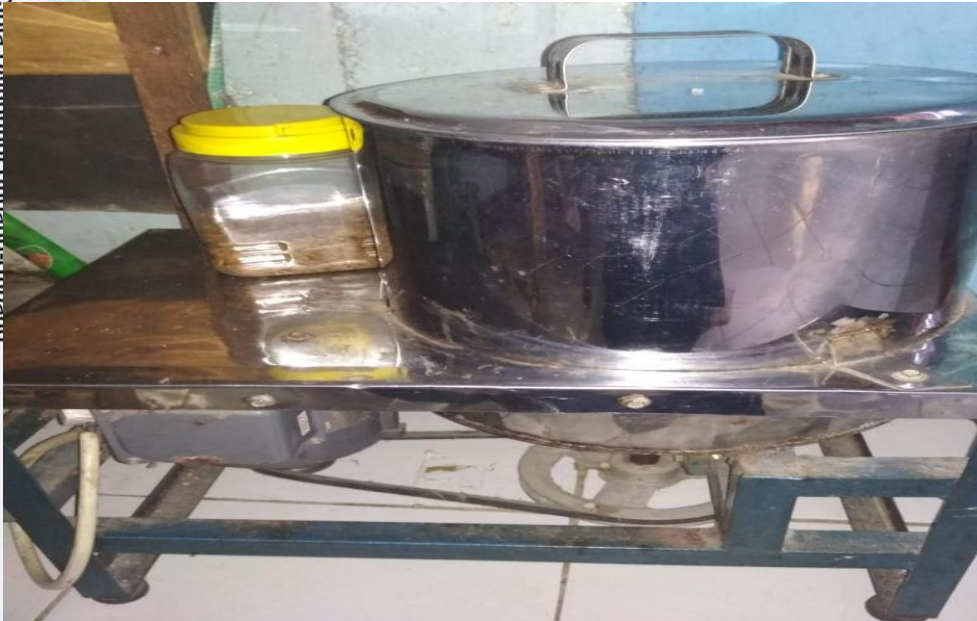
Alat spinner untuk mengeringkan minyak yang melekat di keripik pisang
