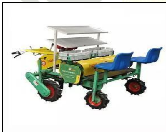
Gambar 1.4 Alat Penanam Tomat Menggunakan Mesin (Sumber : Pengumpulan Data 2021)
