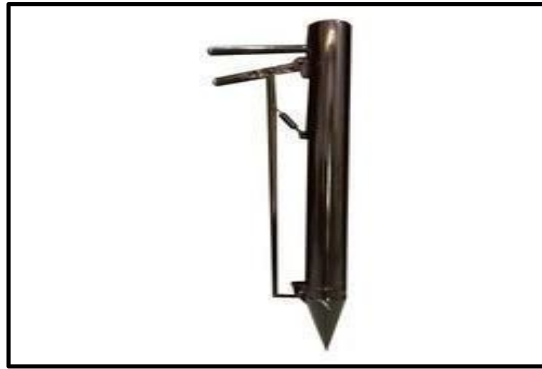
Gambar 1.3 Alat Penanam Tomat Sederhana (Sumber : Pengumpulan Data 2021)
