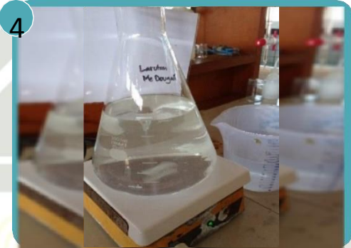
Pemberian larutan McDougall sebanyak 50 ml/botol yang sudah diisi sampel
