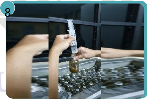
Botol serum dimasukkan ke dalam waterbath suhu 39°C dan Pengambilan Gas
