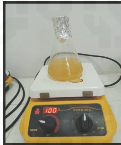
4. Menghomogenkan Media PDA
