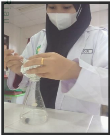
3. Melarutkan NaCl ke dalam Aquades
