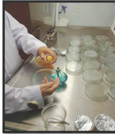
2. Menuangkan Media ke dalam Petri
