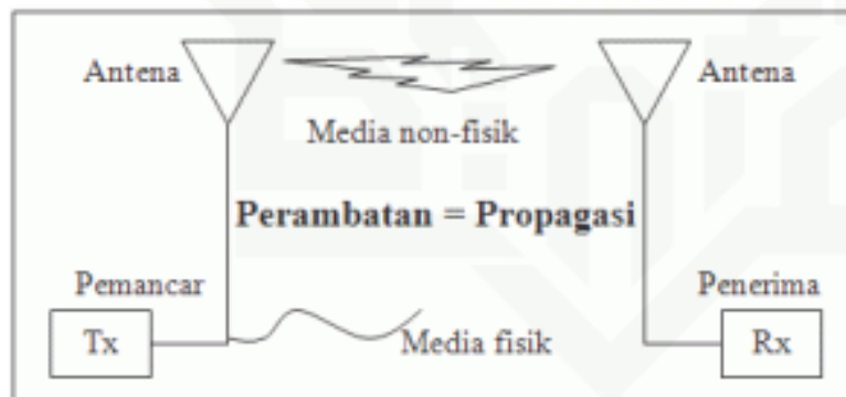
Gambar 2.2 Konsep Antena ( Sumber: Balanies,1982 ) [10]
