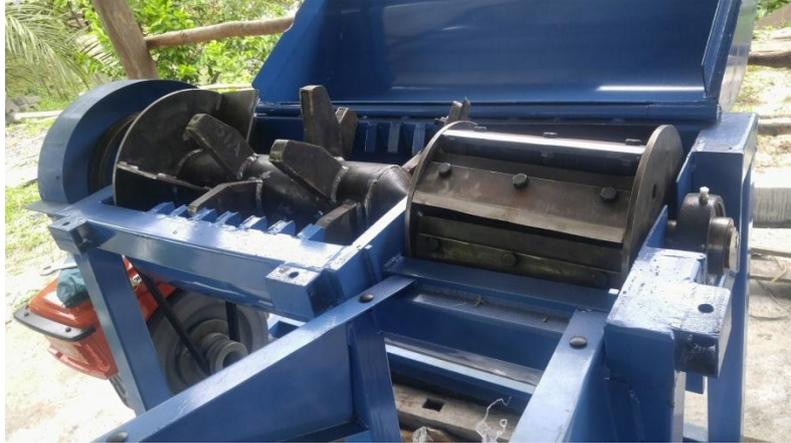
Gambar 2. Mesin untuk Mencacah Pelepah Sawit (bakungpermai.com)
