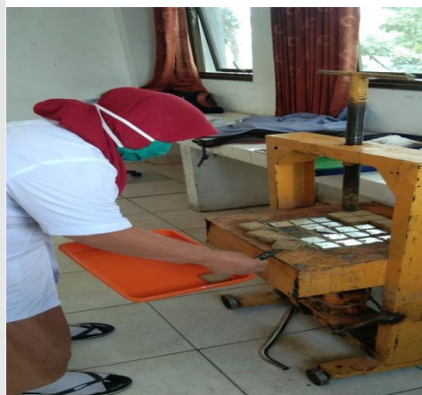
k. Pengangkatan Wafer dari mesin Kempa
