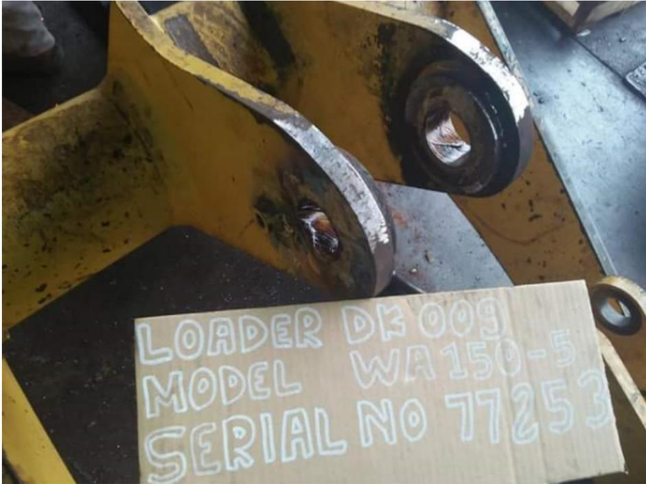
Gambar B.6. Bukti Observasi 1 Hasil *Line Boring* Pada PT. Servitama Internusa
