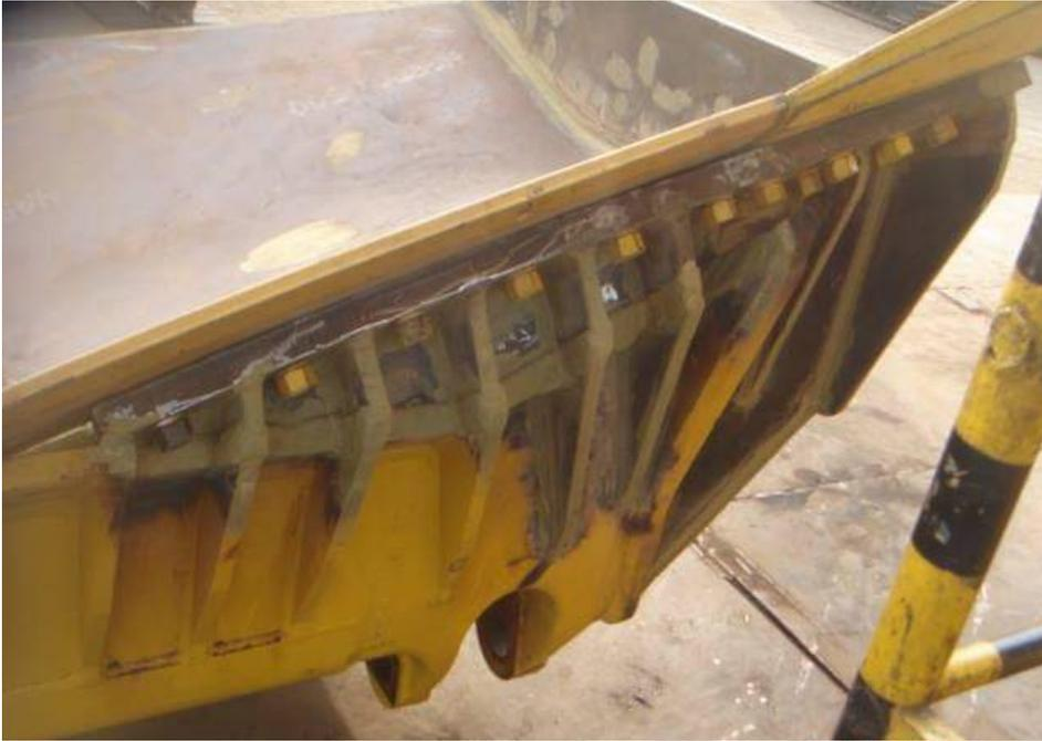
**Gambar B.9.** Bukti Observasi 2 Hasil Modifikasi *Bulldozer Blade* Pada PT. Servitama Internusa
