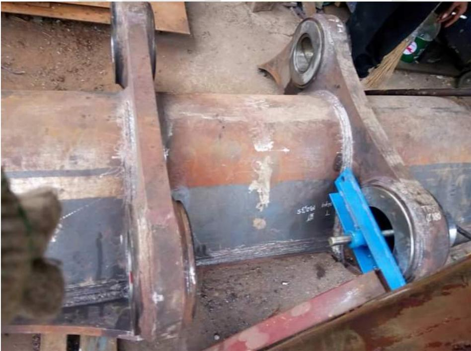
**Gambar B.13.** Bukti Observasi 2 Hasil Modifikasi *Excavator Bucket* Pada PT. Servitama Internusa
