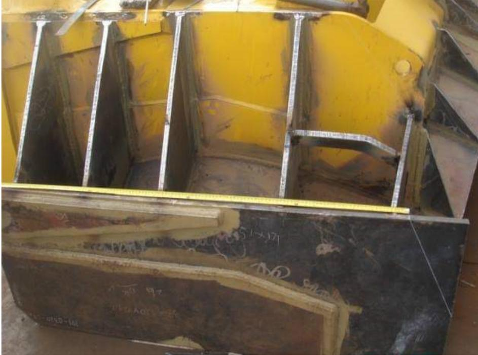
**Gambar B.8.** Bukti Observasi 1 Hasil Modifikasi *Bulldozer Blade* Pada PT. Servitama Internusa
