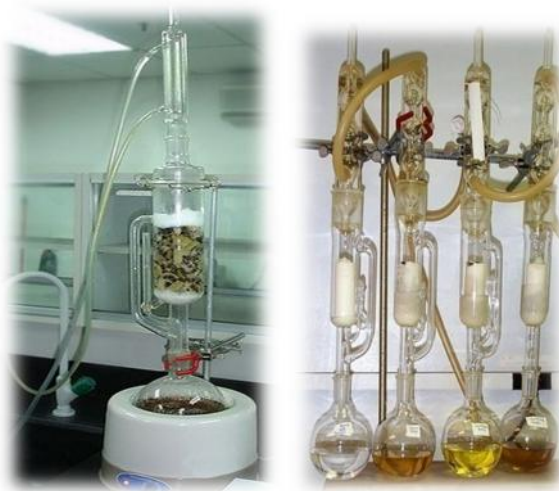
Gambar II.9. Rangkaian alat sokhlet untuk ekstraksi padatan
