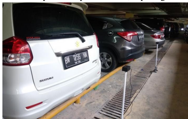
Gambar 5 Penempatan Sensor Parkir pada setiap slot
