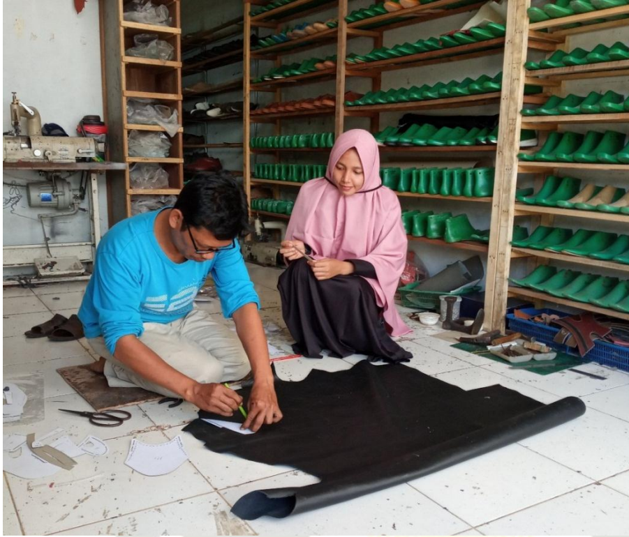
Gambar 3 : Pembuatan Pola yang dilakukan oleh pemilik Usaha Sepatu Kulit “Ciseno” yaitu Bapak Syaripul
