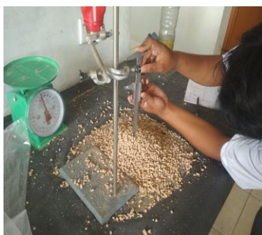
Pengukuran Tinggi Tumpukan
