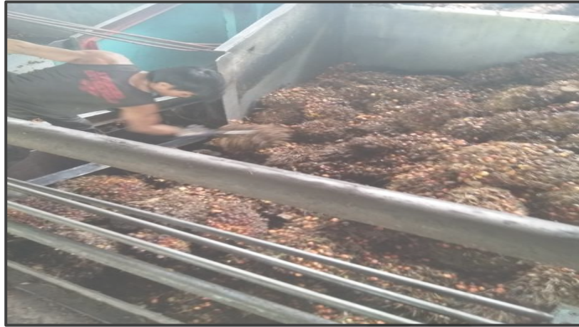
Gambar 4.5 Stasiun Loading Rammp Proses Transfer TBS
