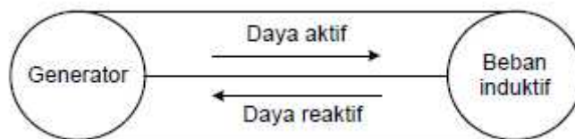
Gambar 2.5.a. Generator tanpa kapasitor[1].
