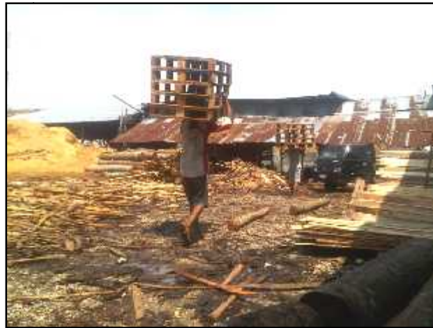
Gambar 1.1. Pekerja mengangkat pallet, dimana lingkungan kerjanya terdapat potongan kayu dan genangan air pada area lintasan pemindahan pallet
