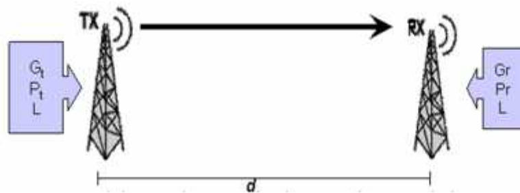
Gambar 2.6 Model perambatan gelombang pada ruang bebas
