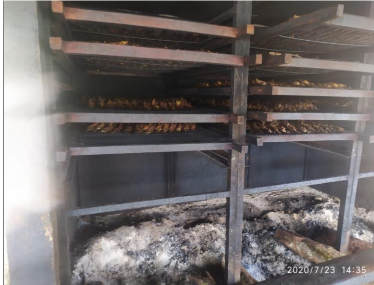
Gambar 4.5 Tungku Penyalai (Sumber: Observasi Lantai Produksi UPTD Pengolahan Dinas Perikanan, 2020)
