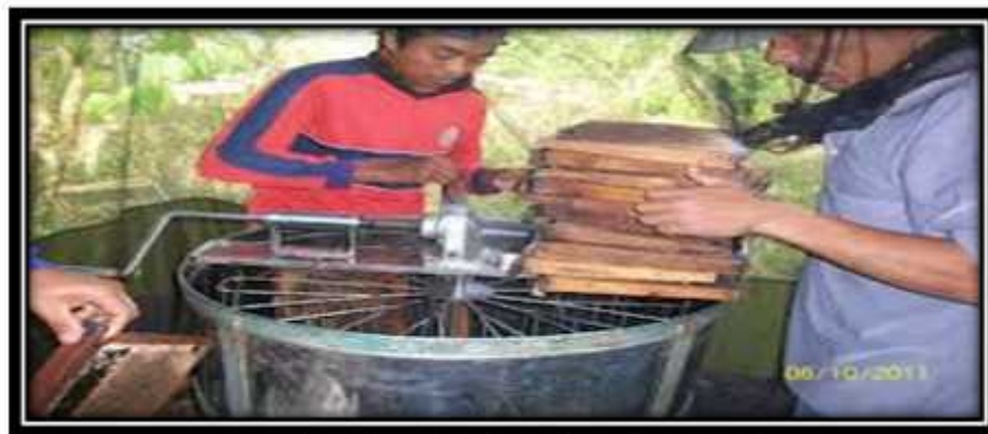
Gambar 1.5 Alat Ekstraktor Madu Sumber : http://ekstraktor+lebah&agrimasdes.blogspot.com
