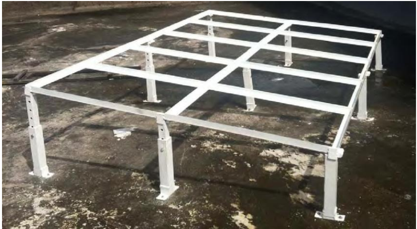
Gambar 89. Pembuatan dukungan modul surya
