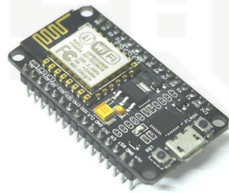
Gambar 2.1 ESP8266 NodeMCU Wi-Fi Module [12]
