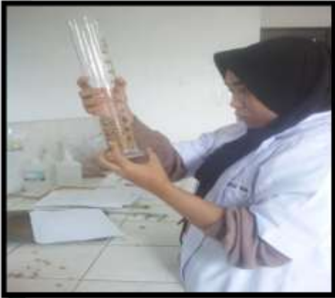
18. Uji kerapatan pematatan tumpukan
