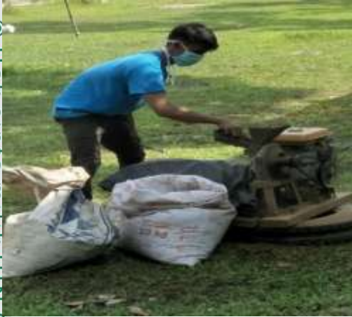
Penggilingan pelepah kelapa sawit fermentasi menggunakan grinder
