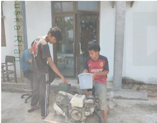
Gambar I. Proses penggilingan daun eceng gondok fermentasi
