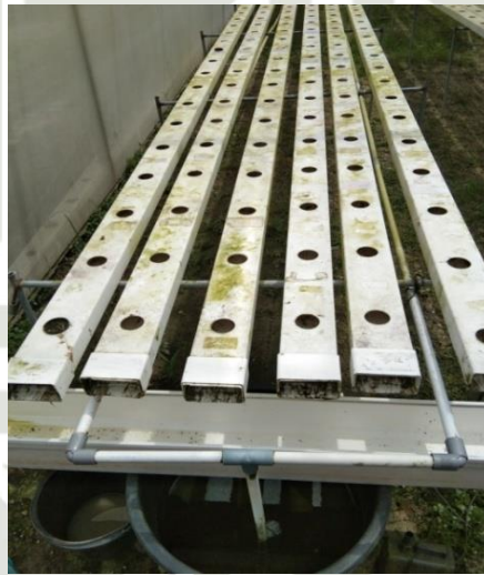
Gambar 2.6. Hidroponik Sistem NFT
