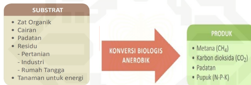
Gambar 2.1. Substrat dan Produk dalam Sebuah Konversi Biologis Anaerobik [5].
