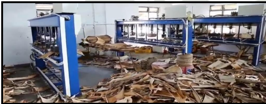
Gambar 1.2 Mesin Pencetak Piring Berbahan Pelepah Pinang (Sumber: Pengumpulan Data, 2019)
