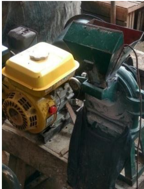
Gambar 3.2. Mesin penggiling Asam (dokumentasi penelitian, 2018)
