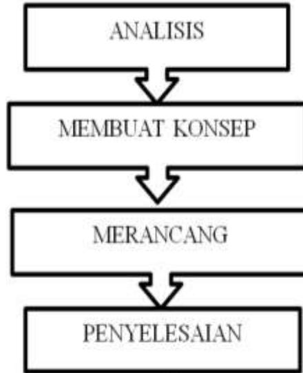
Gambar 2.5 Diagram Alir Perancangan Metode VDI 2222
