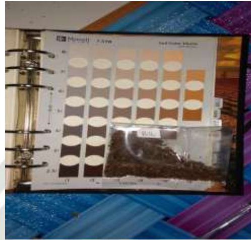
Pengecekan warna menggunakan Munsell chart soil
