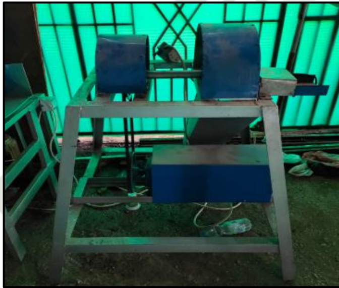
Gambar 1.1 Alat Pemotong Kerupuk Lomang Ubi (Sumber: Lab Teknik Industri UIN Suska Riau, 2020)
