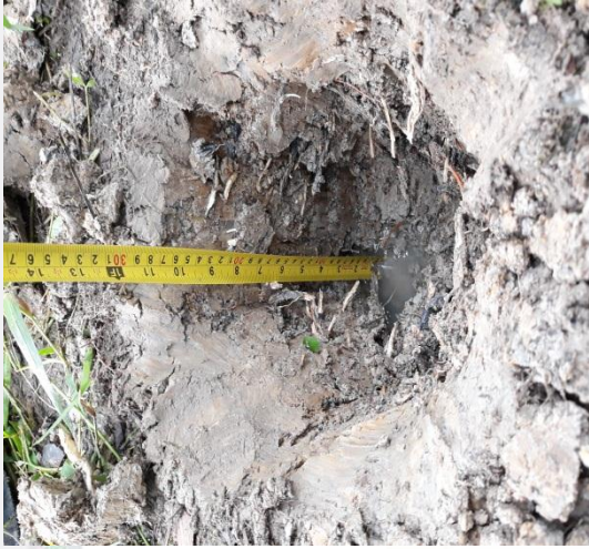
Kedalaman Sampel Tanah 30 cm
