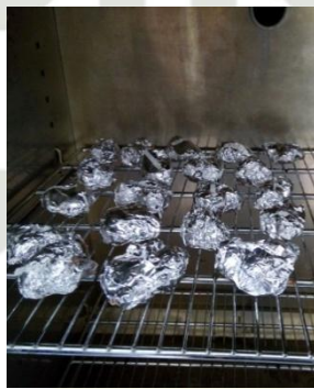
Pengovenan parameter kadar air dan berat kering
