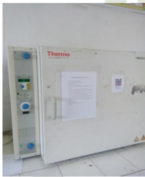
Pengovenan parameter kadar air dan berat kering
