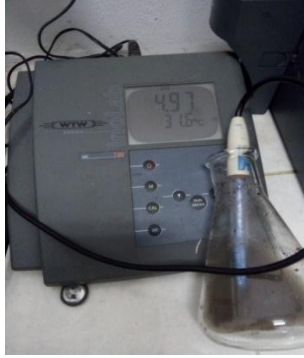
Proses pengukuran pH tanah
