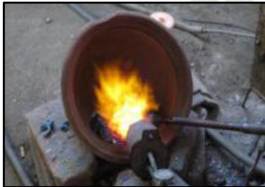
Gambar 2.1 Peleburan Limbah Kaca Tradisional dengan Tembikar (Sumber: Pengumpulan Data, 2019)
