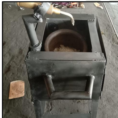
Pemasangan Pegangan Tungku
