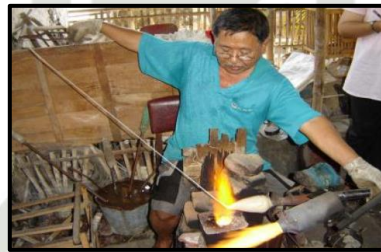
Gambar 2.2 Metode Tarik (Sumber: Pengumpulan Data, 2019)
