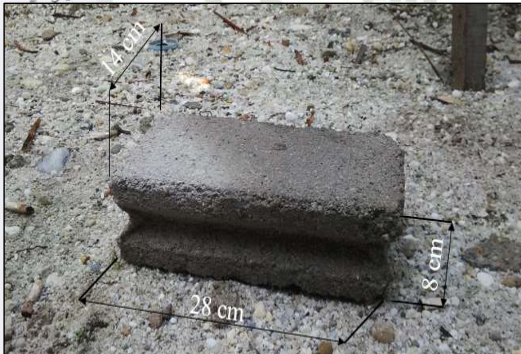
Gambar 4.1 Dimensi Batako (Sumber: Pengumpulan Data, 2018)
