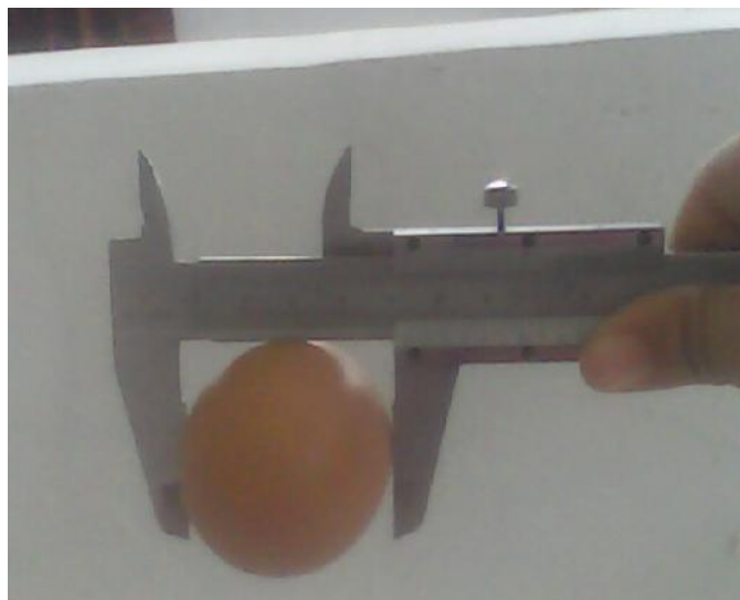
Gambar 2. Teknik Pegukuran Diameter Telur
