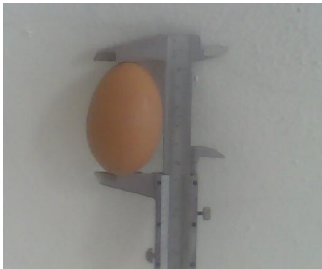
Gambar 3. Teknik Pengukuran Panjang Telur
