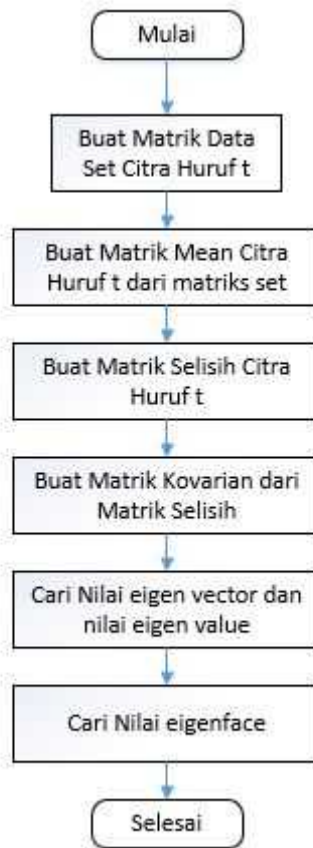
Gambar 4.3 Flowchart PCA sistem klasifikasi tulisan huruf t
