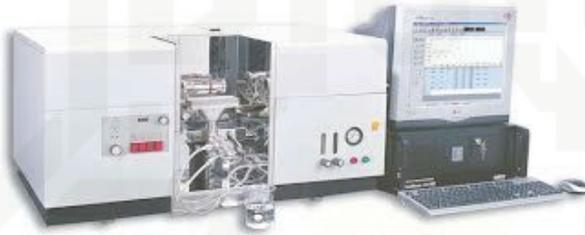
**Gambar 2.6** Spektrofotometri Serapan Atom (SSA)
