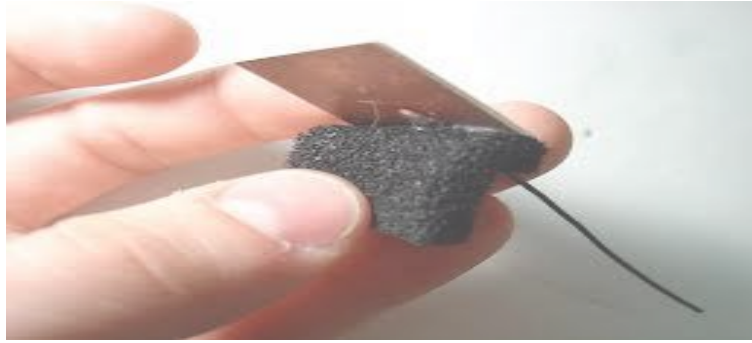
Gambar 2.17. Foam Konduktif dapat digunakan sebagai bahan FSR.
