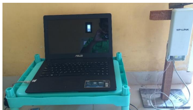
Gambar 3.20 Perangkat yang Bertindak sebagai Access Point atau Transmitter
