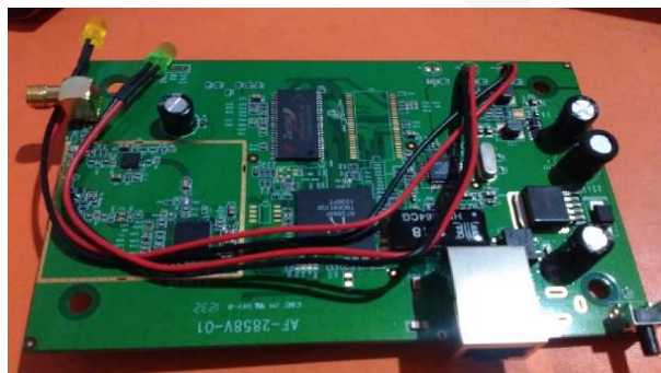
Gambar 3.12 Perangkat radio ( radio board ) ARGTEK PCBA 2618
