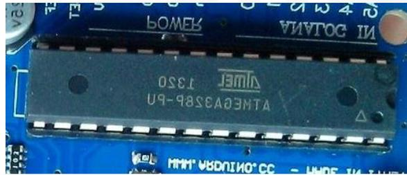
Gambar 2.6 Mikrokontroler 328P
