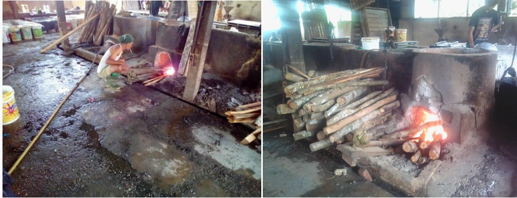
Gambar 4.10 Stasiun perebusan yang belum rapi (kiri) stasiun yang telah di rapikan (kanan) (Sumber: CV. Dhika Putra)
