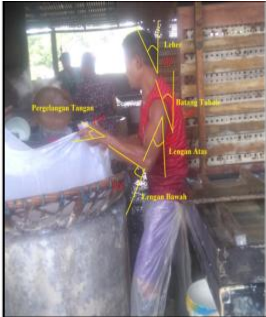
Gambar 4.16 Sudut Pengukuran Metode RULA untuk Postur Tubuh Ketiga (Sumber: CV. Dhika Putra)
