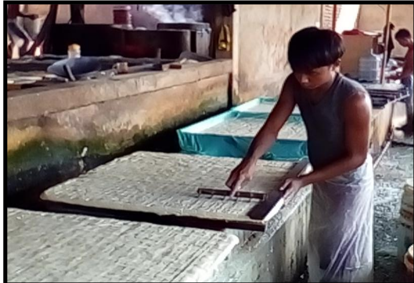
Gambar 4.7 Proses pemotongan tahu (Sumber: CV. Dhika Putra)
