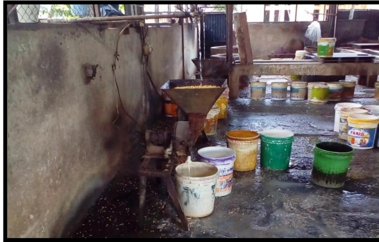
Gambar 4.3 Proses penggilingan kedelai (Sumber: CV. Dhika Putra)
