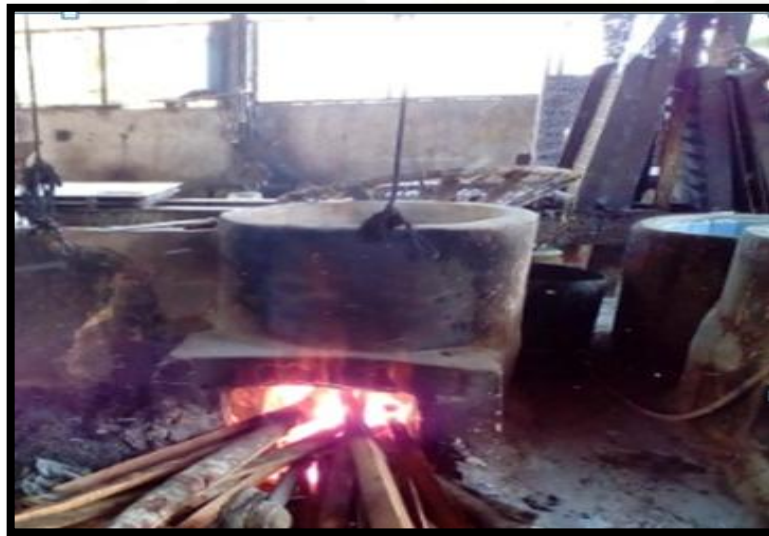
Gambar 4.4 Proses merebus kedelai (Sumber: CV. Dhika Putra)
