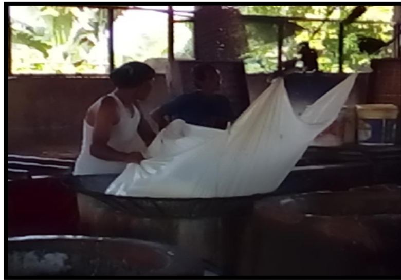
Gambar 4.5 Proses penyaringan kedelai (Sumber: CV. Dhika Putra)
