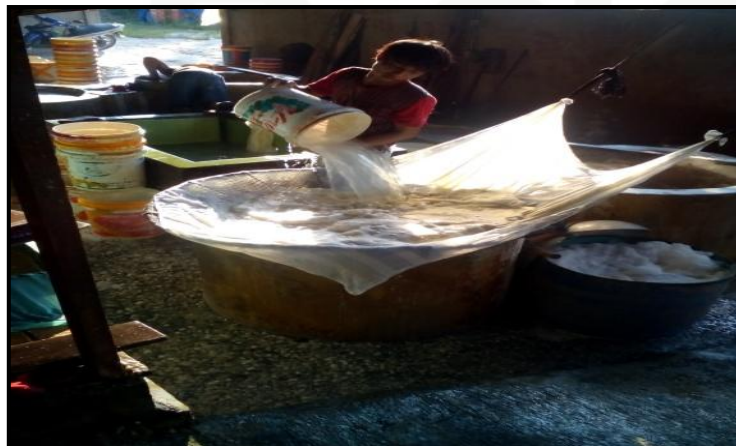
Gambar 1.4 Proses pengayakan hasil rebusan (Sumber: CV. Dhika Putra, 2016)
