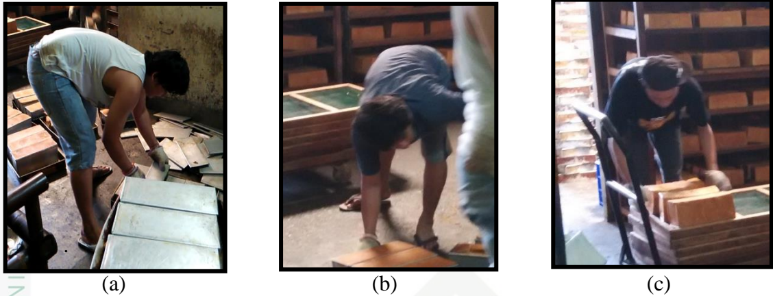
Gambar 1.1 (a) Mengambil dan Meletakkan Roti dari Oven ke Lantai dan Membuka Tutup Loyang (b) Mengambil Roti dari ke Pekerja Satu dan Mengeluarkan Roti dari Loyang (c) Menyusun Roti ke Plat Rak
