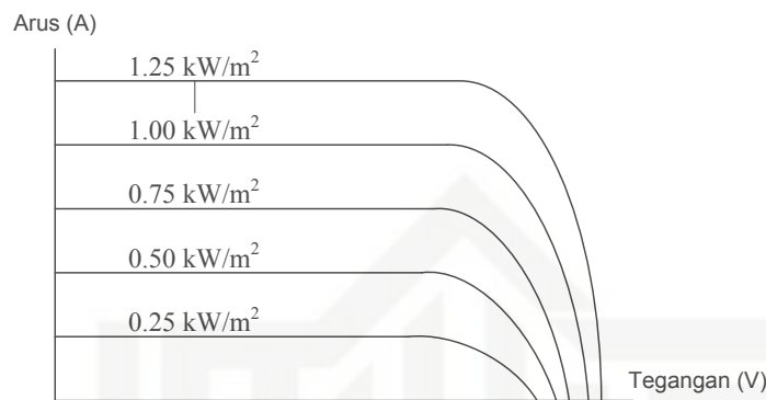
Gambar 2.8 Karakteristik variasi tegangan terhadap radiasi [16]
