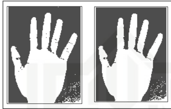
Gambar 4.7 Median filtering pada citra binary image
