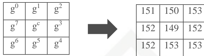
Gambar 4.10 Nilai piksel ketetangaan dari piksel (2,2)
