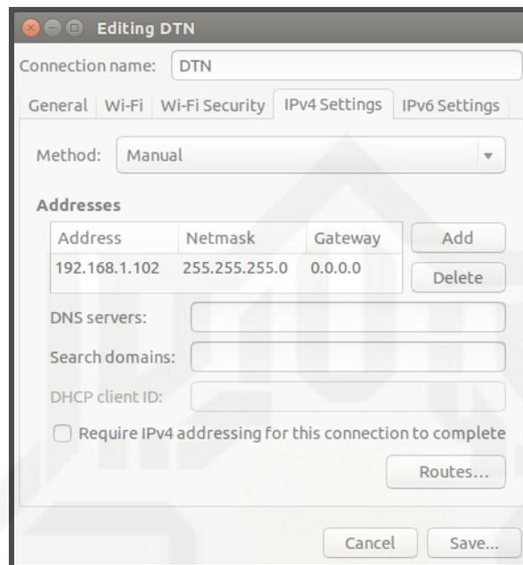
Gambar 3.6 Konfigurasi *IP address Node 1*
