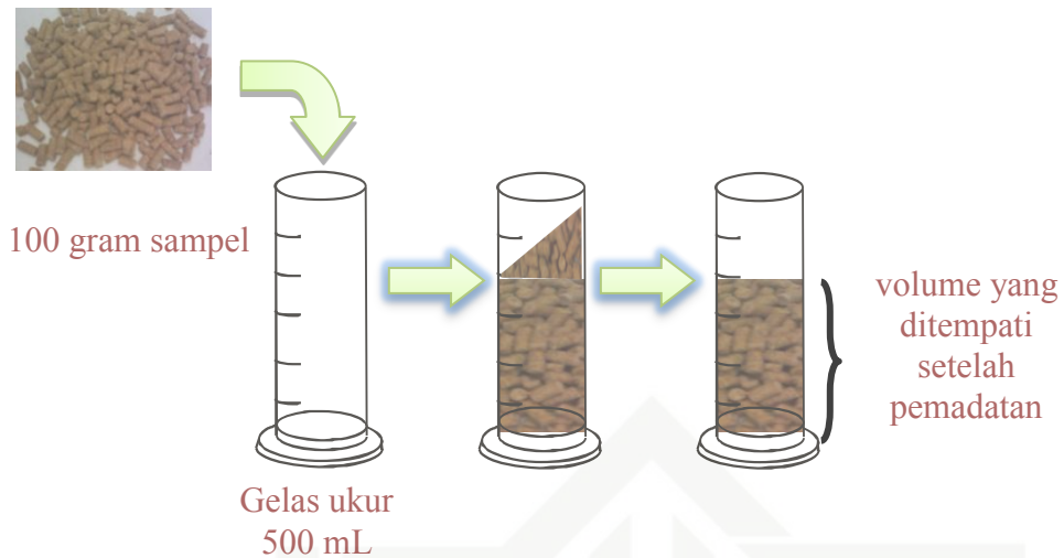
Gambar 3.6. Penentuan kerapatan pemadatan tumpukan pellet
