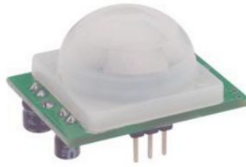
Gambar 2.6 Sensor PIR (Zain, 2013)
