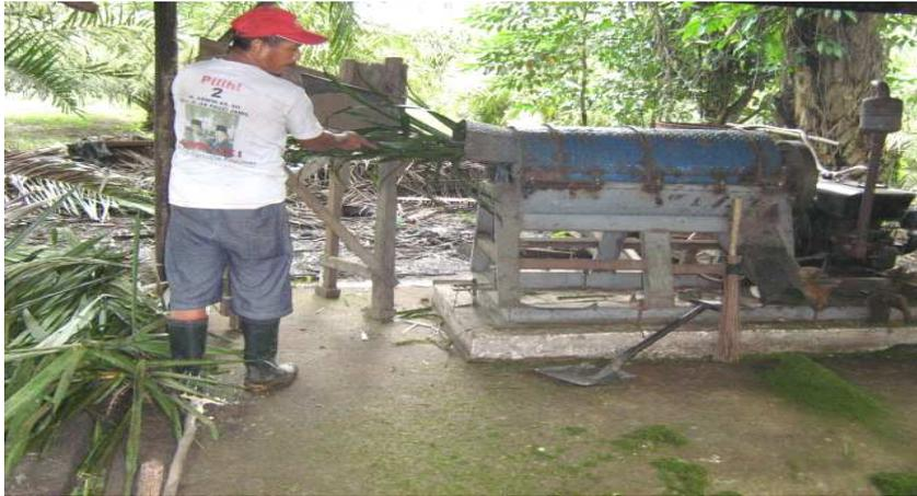
Gambar 2. Proses Pencacahan Pelelah Kelapa Sawit dan *leaf chopper* yang Digunakan.
